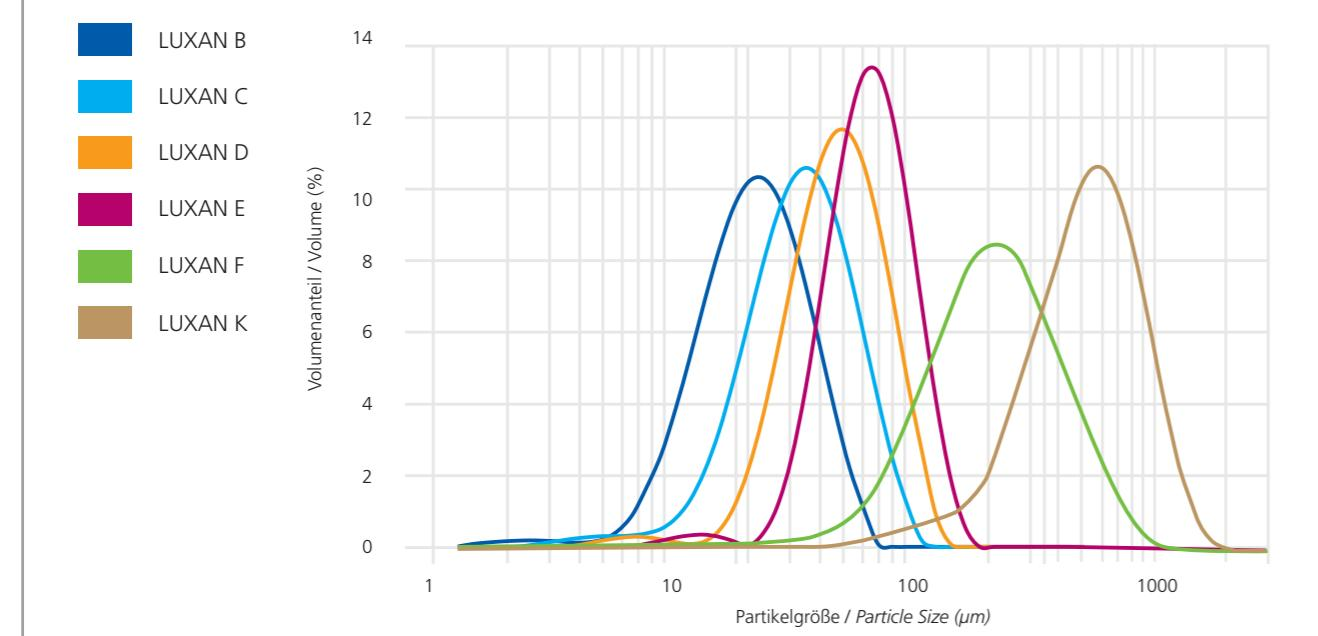
Methode Lasergranulometrie nach ISO 13320-1 / Method Laser Granulometry ISO 13320-1
