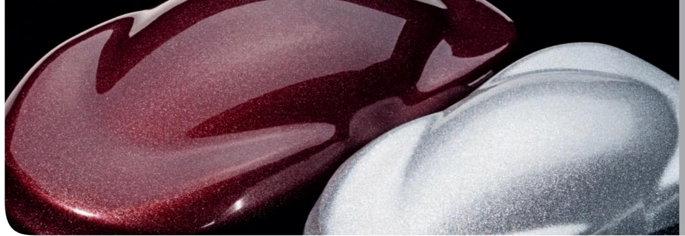
Die Herstellung von Metallic- und Perlglanzeffekt-Pulverlacken besitzt gewisse Besonderheiten und zeigt einige Merkmale, die sich vom Produktionsprozess gewöhnlicher Pulverlacke (die anorganische oder organische Buntpigmente enthalten) unterscheiden. Die Notwendigkeit, vom sonst für Pulverlacke üblichen Produktionsschema abzuweichen, ist im Wesentlichen auf die plättchenförmige Struktur der Metallic- und Perlglanzeffekt-pigmente zurückzuführen.
